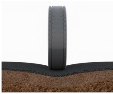
Filterkangata paigaldatud pinnasematerjalid hakkavad segunema ja vajuma.
